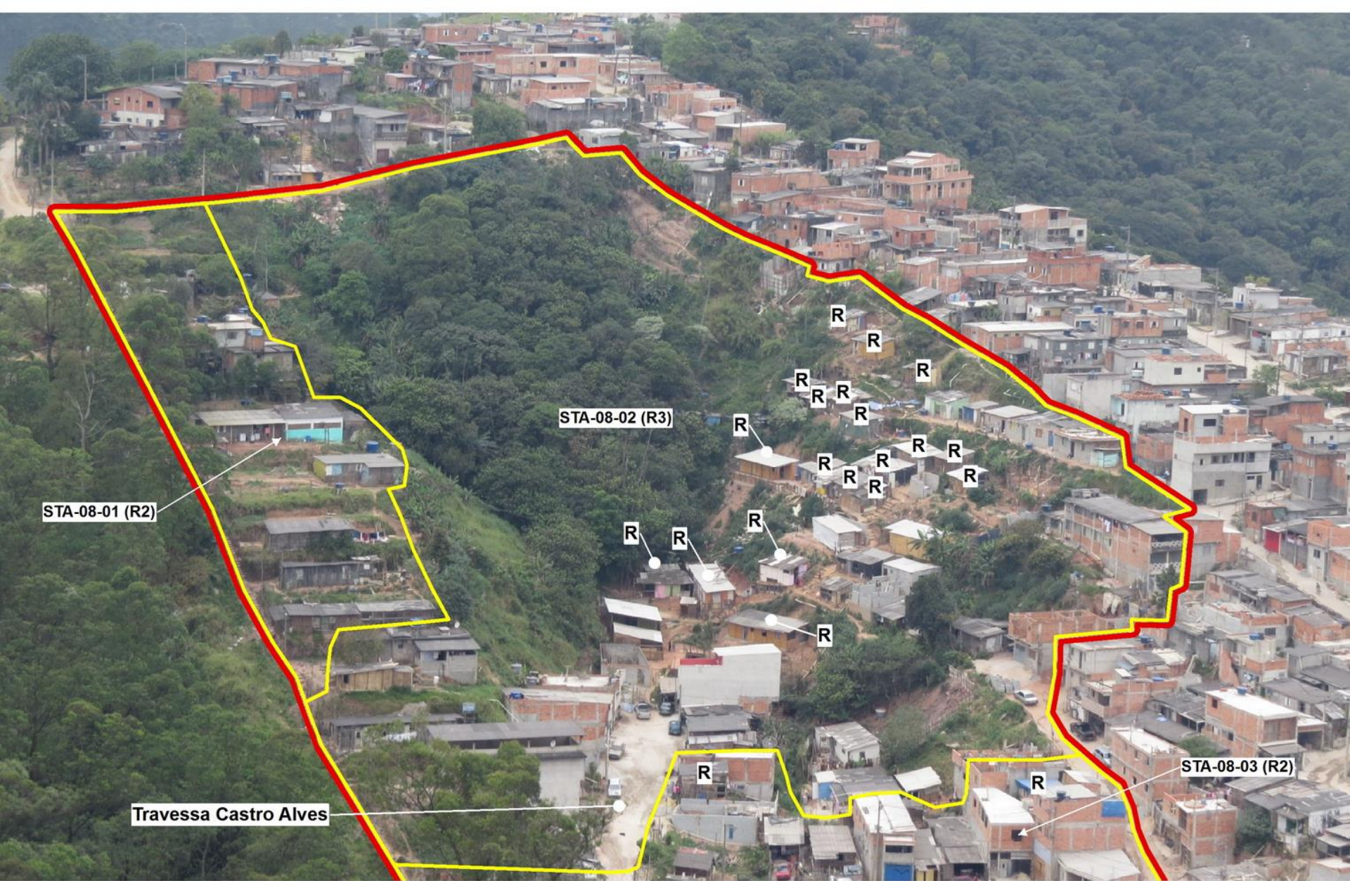
FOTO FH-STA-08.01: Vista dos setores mapeados. As moradias marcadas com R são indicadas para remoção.
